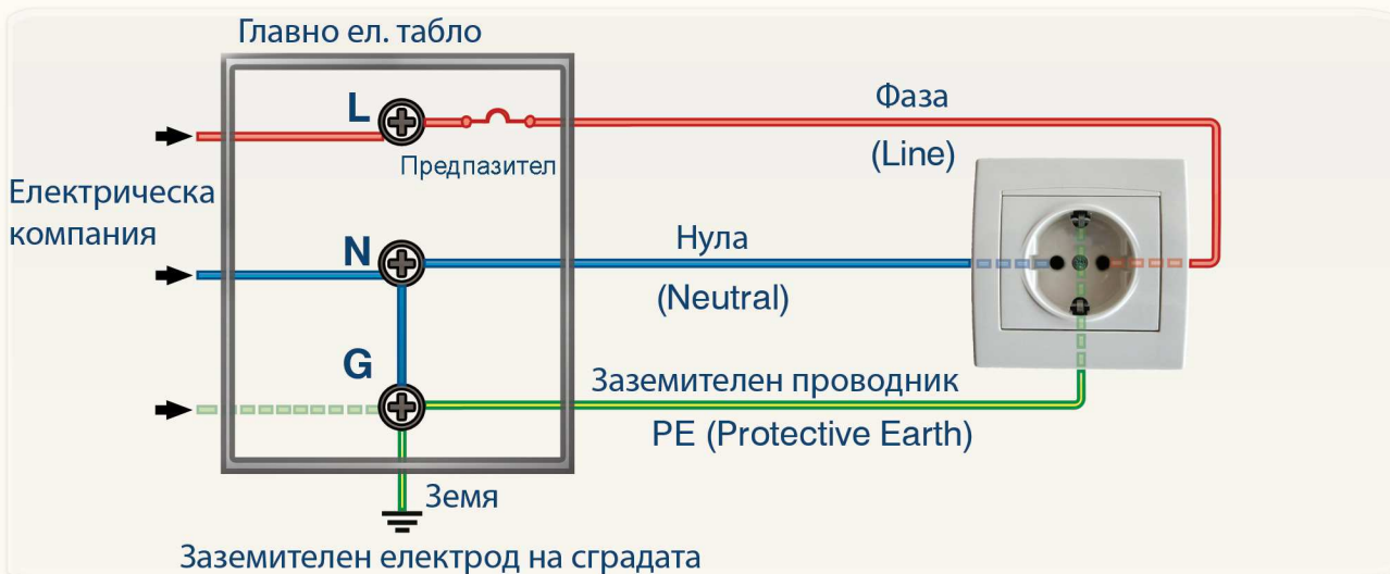
Трипроводна ел. инсталация
