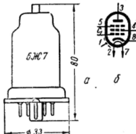
Предназначен для усиления напряжения высокой частоты.
