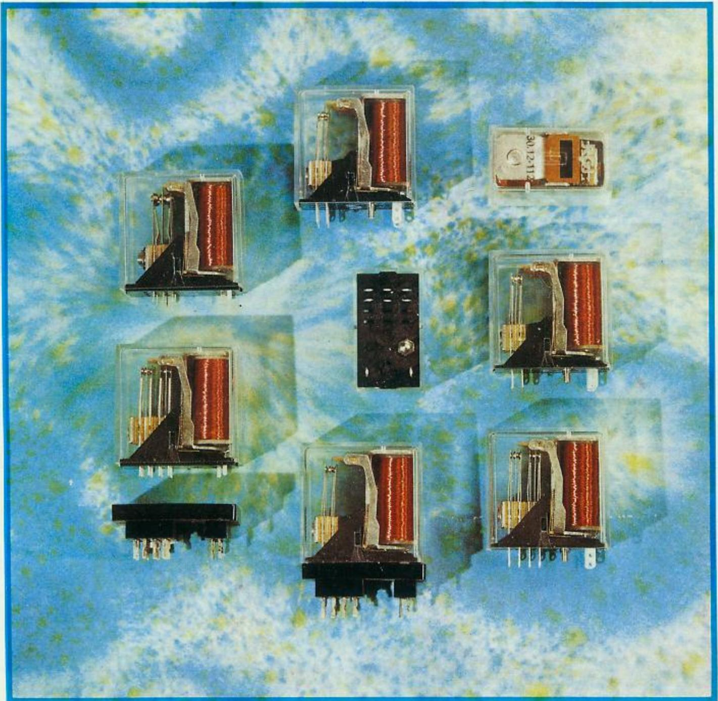
Relais NSF 30 nach TGL 200-3796 gehören zu einer international weit verbreiteten und bewährten Ausführung von Kleinrelais. Vom Konstruktionsprinzip her sind sie den Klappankerrelais zuzuordnen. Aufgrund der charakteristischen Übertragung der Ankerbewegung auf die Federsätze werden sie verschiedentlich auch als Kammrelais bezeichnet. Bei den meisten der für diese Relais infrage kommenden Einsatzfälle sind die zur Verfügung stehenden 2 bzw. 4 Umschalter mit Einfachkontakt ausreichend.
